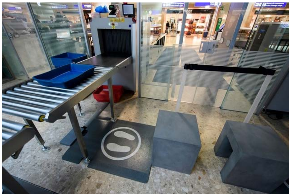
Beschleunigt die Sicherheitskontrolle am Flughafen Genf: die Teppiche mit Sensoren. Foto: Keystone
